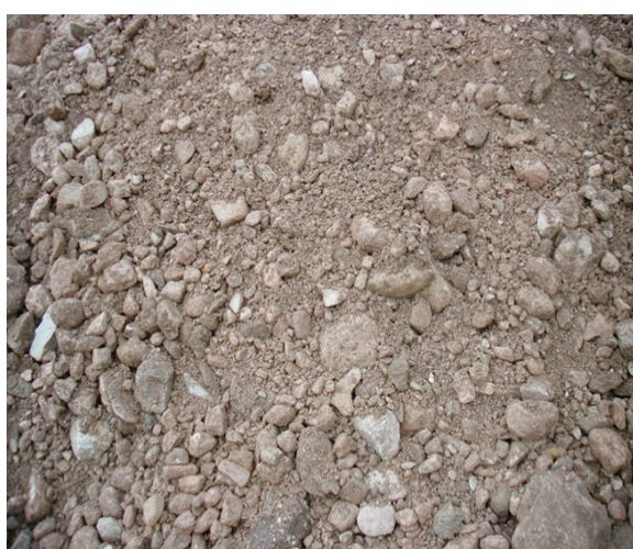
17 09 04 Misti composti da materiale costituente il corpo stradale ...
